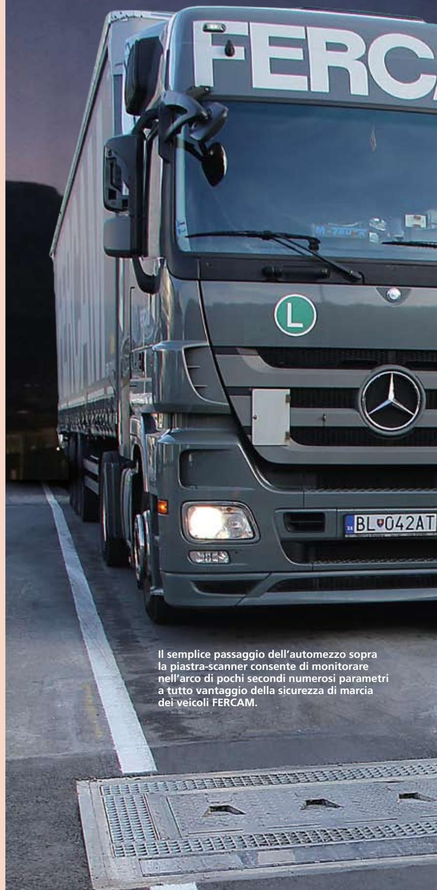
Il semplice passaggio dell'automezzo sopra la piastra-scanner consente di monitorare nell'arco di pochi secondi numerosi parametri a tutto vantaggio della sicurezza di marcia dei veicoli FERCAM.
